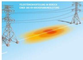
Unter einer Hochspannungsleitung ist das Feld dort, wo die Leitungen durchhängen, am größten. (Grafik: Bundesamt für Strahlenschutz) (Foto: Bundesamt für Strahlenschutz)
